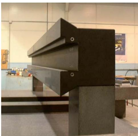
*Dans le cas de dimensions plus importantes, les faces de guidage peuvent être rodées si leur écartement permet le passage d'un rodoir et des moyens de contrôle.*
